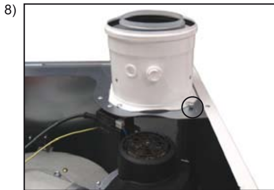
8) Po zdjęciu górnej pokrywy obudowy poluzować blachowkręt zabezpieczający rurę powietrzno-spalinową.
